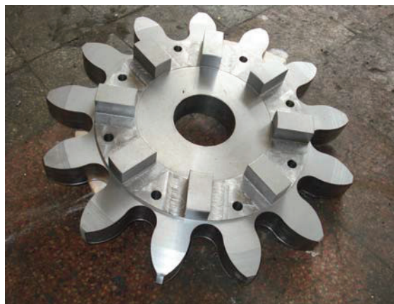
Фиг.8. Изработен детайл след добавяне на въртящата се маса.
