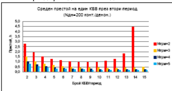
Фиг. 5. Среден престой на един КБВ през втори период при N_{dn}=200 конт./денон.
