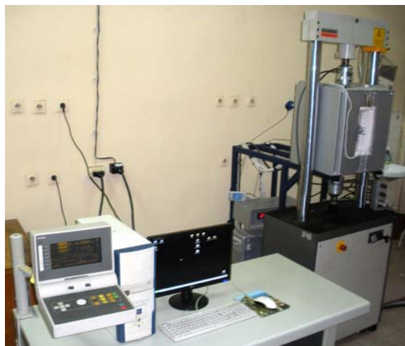
Фиг. 8. Системата за изпитване на материалите при повишени температури и променливо натоварване.
