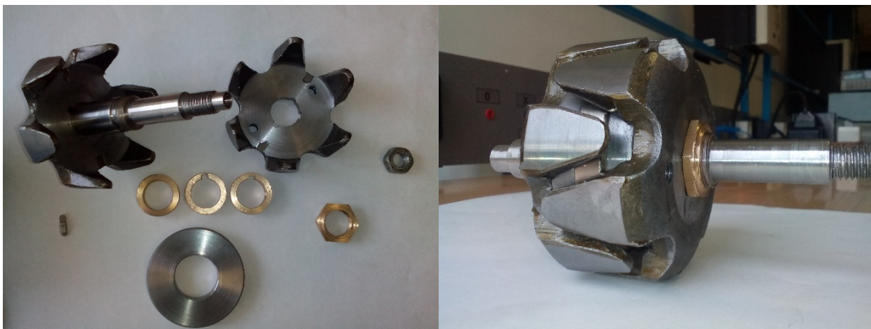
Фиг.1 Модифициран ротор на алтернатора.
