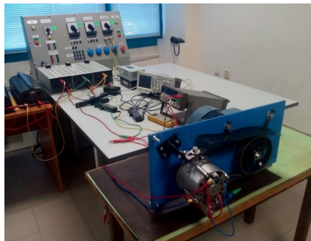
Фиг.3 Опитна постановка за изследване на алтернатори.
