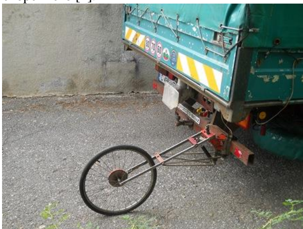
Фиг. 1. Измерителна апаратура тип „пето колело“.
