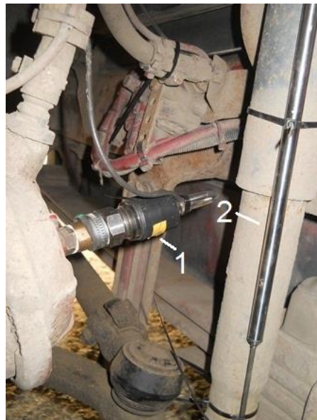
Фиг. 2. Възприемател за налягане на спирачната камера на предното колело (1) и възприемател за преместване на колелото спрямо рамата (2).
