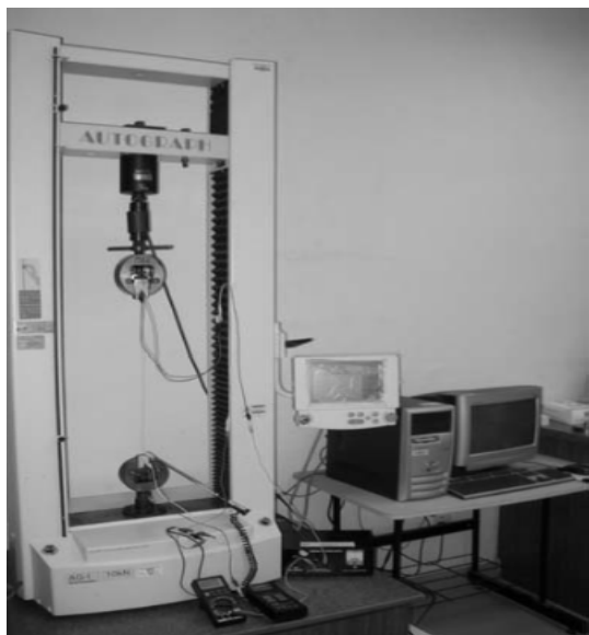
Фиг. 3 Стенд за изследване на фазови температурни трансформации при СПФ в Световна Академия на науките, инженерството и технологиите [5]
