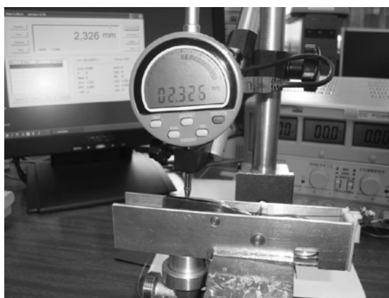
Фиг. 4 Стенд за изследване на радиаторни клапани управлявани чрез СПФ разработен в катедра ТММ, ТУ-София [1].
