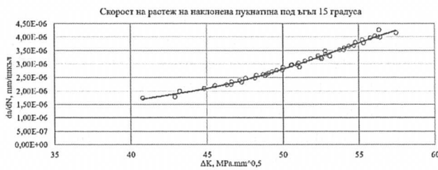
Фиг. 2. Зависимост между скоростта на растеж на пукнатината и коефициента на интензивност на напреженията при наклон 15^\circ
