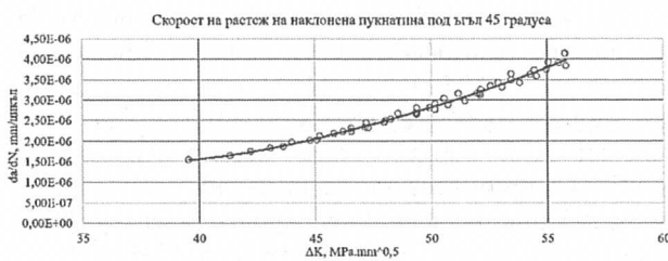
Фиг. 4. Зависимост между скоростта на растеж на пукнатината и коефициента на интензивност на напреженията при наклон 45^\circ
