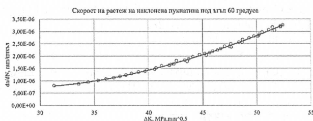
Фиг. 5. Зависимост между скоростта на растеж на пукнатината и коефициента на интензивност на напреженията при наклон 60^\circ
