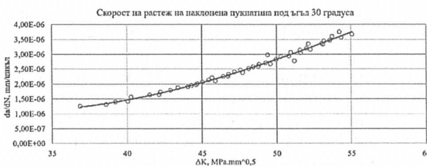
Фиг. 3. Зависимост между скоростта на растеж на пукнатината и коефициента на интензивност на напреженията при наклон 30^\circ
