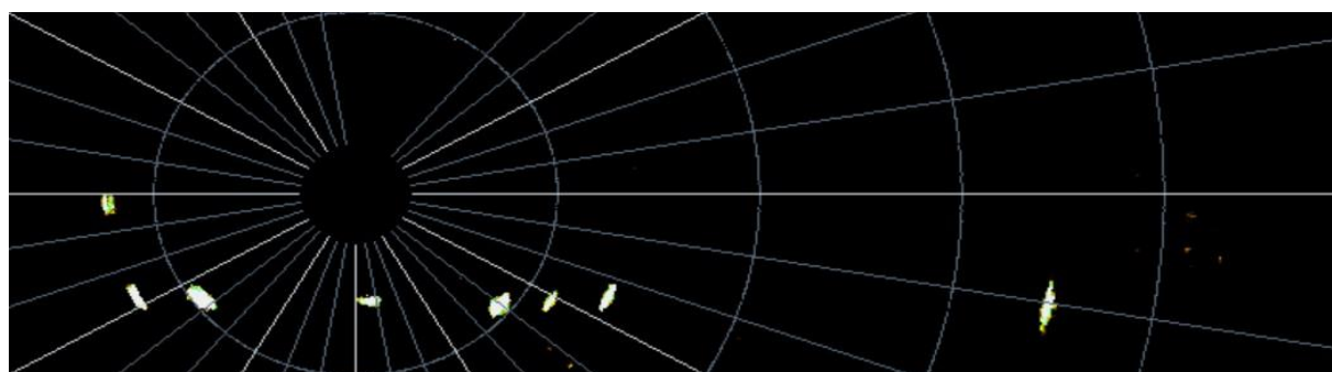
Фиг. 14. Ехо сигнал, който се получава след изваждане на фона от полученото ехо, съответно за фазовия канал.
