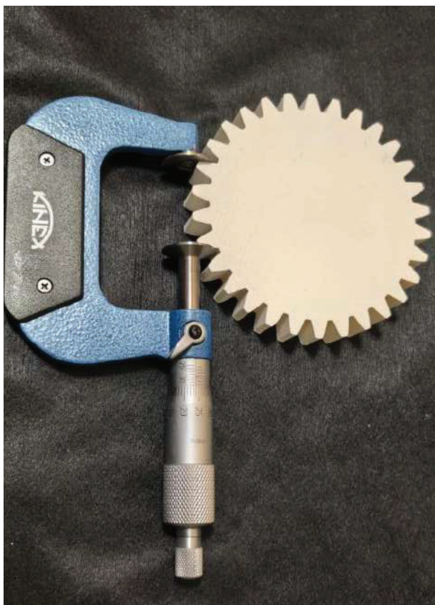
Фиг. 5. Измерване на обща нормала
