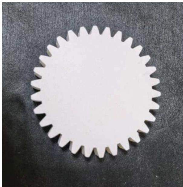
Фиг. 4. Отпечатан опитен образец
