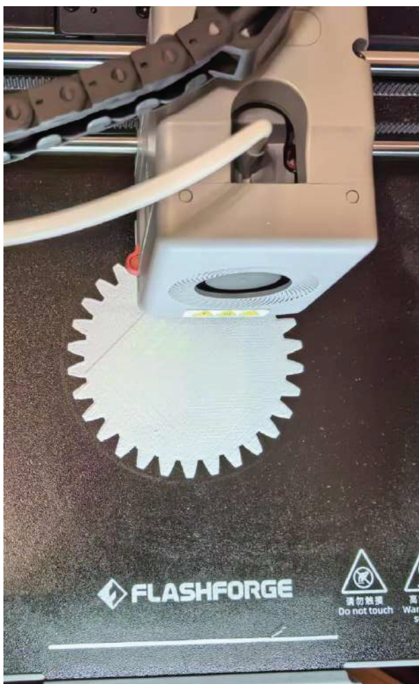
Фиг. 3. Печат на 3D модел на зъбно колело
