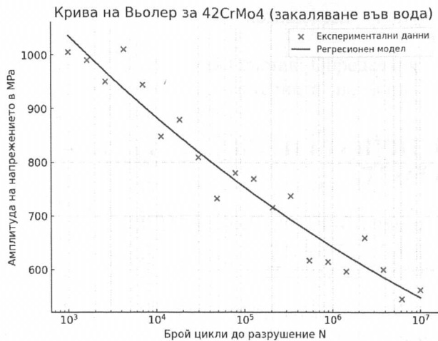
Фиг. 5 Резултати от изследването на стомана 42CrMo4 след закаляване във вода.
