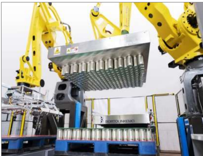
Снимка XI – 7. Депалетизатор за малки метални опаковки (кенове) на Bortolin Kemo S.p.A.
