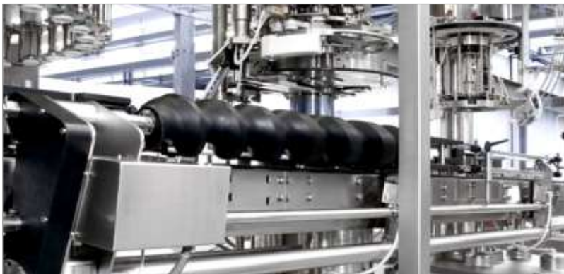
Снимка XI – 2. Универсален, моторизиран шнек (винт) на MBF S.p.A.
