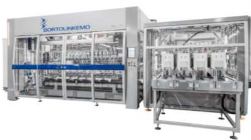
Снимка XI – 98. Автоматична машина за вземане и поставяне на бутилки модел IAX на Bortolin Keto S.p.A.
