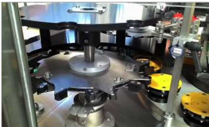
Снимка XI – 90. Многофункционално звездообразно колело (звезда) част от етикетираща машина на CAVAGNINO & GATTI S.p.A.
