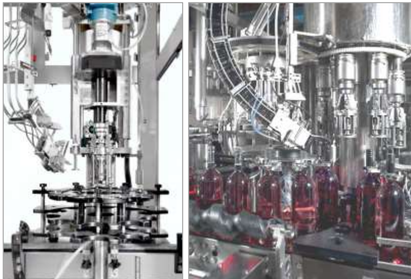
Снимки XI – 33 и 34. Затварящи машини с една и няколко затварящи глави на MBF S.p.A.
