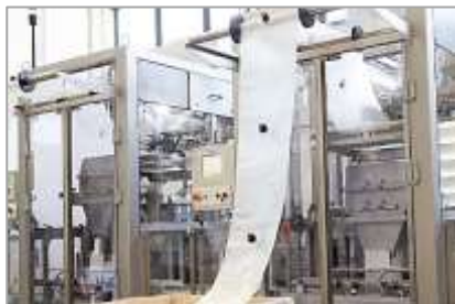
Снимки XIII – 1 и 2. Автоматично подаване на торбичките и захващане на крана на торбичката на машини на SACMI IMOLA S.C.
