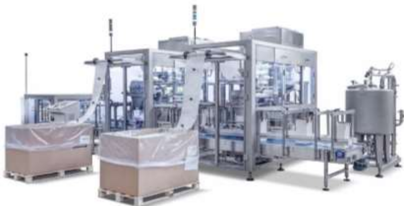
Снимка XIII – 7. Автоматична машина за пълнене на бег ин бокс опаковки на SACMI IMOLA S.C.
