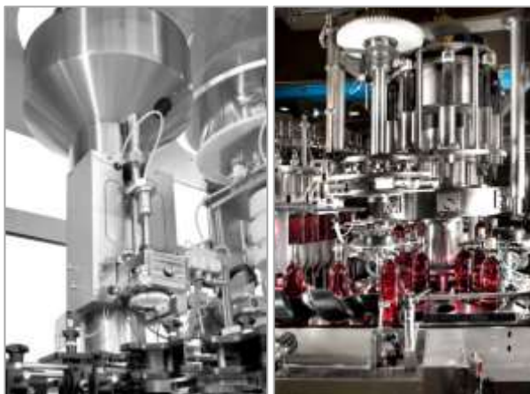
Снимки XI – 27 и 28. Запушващи машини с една и няколко затварящи глави (игли) на MBF S.p.A.
