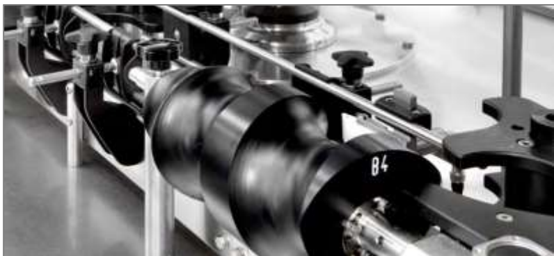
Снимка XI – 13. Насочващ шнек от плакначна машина на фирма MBF S.p.A.
