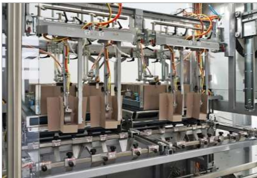
Снимки XI – 104 и 105. Част от работния процес отвътре на машина за поставяне на прегради вътре в кашона на Bortolin Кето S.p.A.
