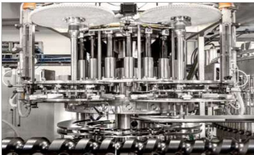
Снимка XI – 29. Запушваща машина с няколко затварящи глави (угли), базов вариант CORKMATIC на MBF S.p.A.
