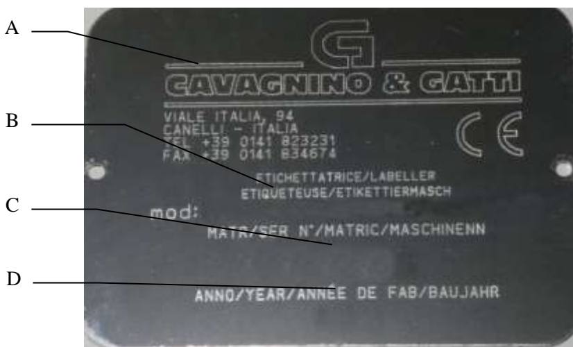
Снимка XI – I. Идентификационна табела (етикет) на машината от CAVAGNINO & GATTI S.p.A.
