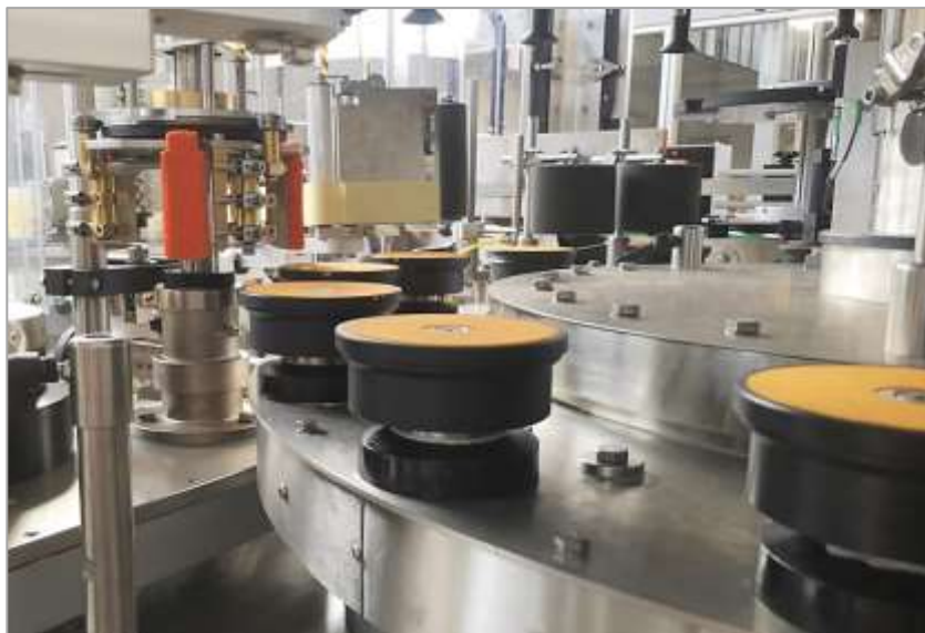
Снимка XI – 89. Програмируеми въртящи се платформи за бутилки, част от етикетираща машина на CAVAGNINO & GATTI S.p.A.
