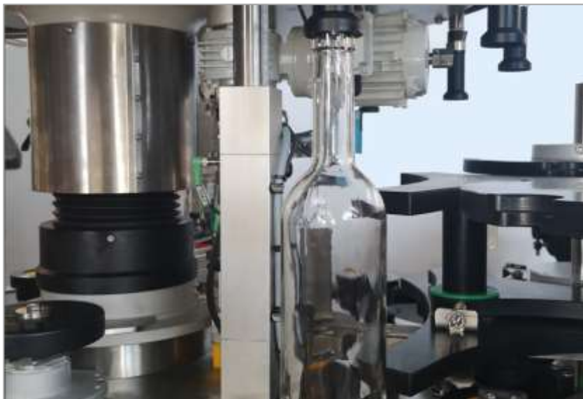
Снимка XI – 92. Момент от автоматичното регулиране на горния каросел от етиктираща машина на CAVAGNINO & GATTI S.p.A.
