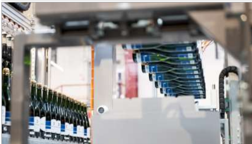
Снимки XI – 99 и 100. Част от работния процес отвътре на автоматична машина за вземане и поставяне на бутилки модел IAX на Bortolin Kemo S.p.A.
