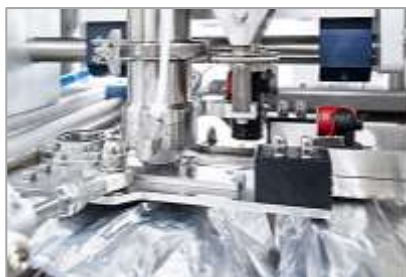
Снимки XIII – 3 и 4. Позициониране на крана на торбичката и автоматично поставяне на торбичката в кутия машини на SACMI IMOLA S.C.
