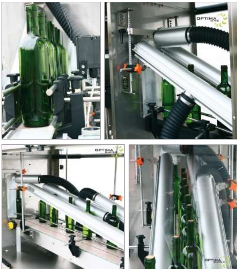
Снимки XI –73, 74, 75 и 76. Изсушаване на бутилки от миячно – сушилна машина на OMAR R&G s.r.l.
