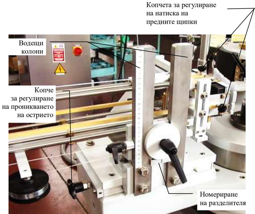
Снимка XI – 84. Част от етиктираща машина за етикети с мокро лепило на CAVAGNINO & GATTI S.p.A., на която са показани копчетата за регулиране
