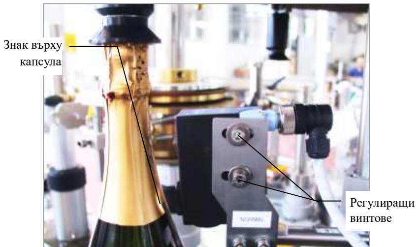
Снимка XI – 77. Оптично устройство с единична фотоклетка на CAVAGNINO & GATTI S.p.A. по време на работа с бутилка шумящо вино
