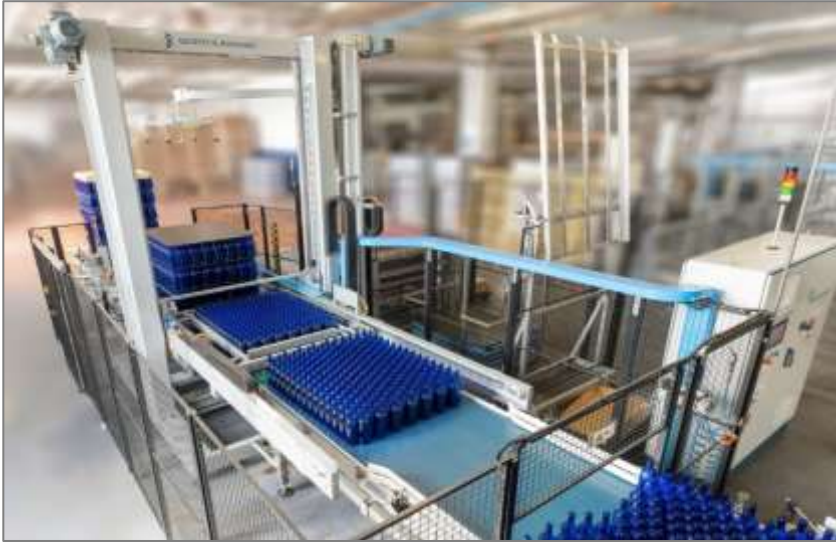
Снимки XI – 8,9 и 10. Етапи от работата на автоматичната система за депалетизация модел DEP на Bortolin Kemo S.p.A.
