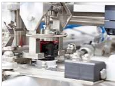
Снимки XIII – 1 и 2. Автоматично подаване на торбичките и захващане на крана на торбичката на машини на SACMI IMOLA S.C.
