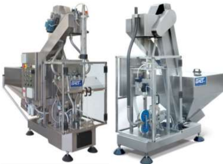
Снимки XI – 25 и 26. Машини за ориентиране на тапи марка Cames модели P.DUE-E и ALX-10, представлявани от OMAR R&G s.r.l.
