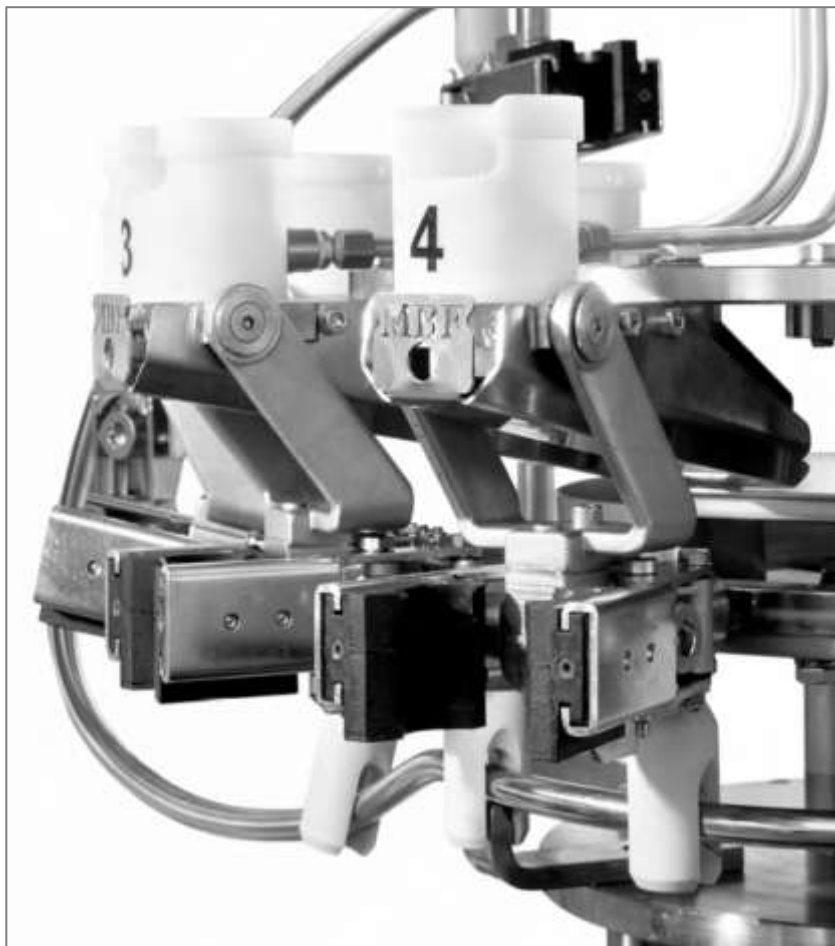
Снимка XI – 15. Захващащ механизъм за бутилки от плакначна машина на фирма MBF S.p.A.
