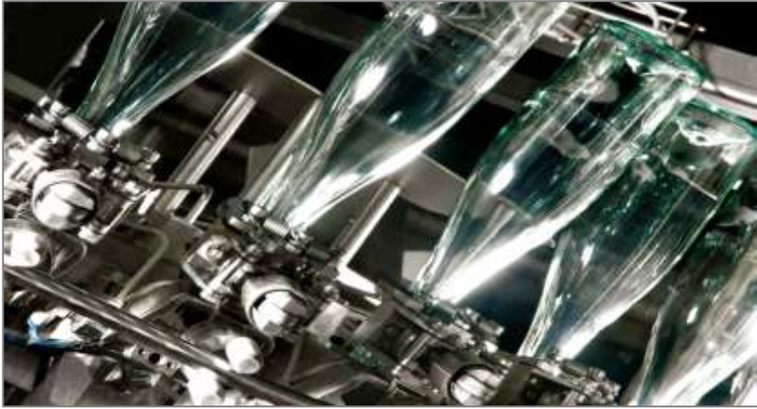
Снимка XI – 16. Бутилки, които са захванати и обвърнати с гърловината надолу в момента преди изплакването им в плакначна машина на фирма MBF S.p.A.
