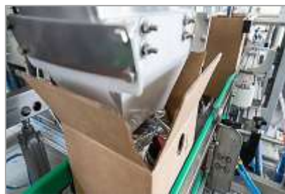
Снимки XIII – 3 и 4. Позициониране на крана на торбичката и автоматично поставяне на торбичката в кутия машини на SACMI IMOLA S.C.
