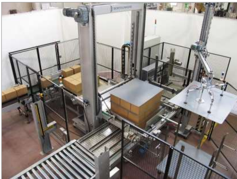
Снимка XI – III. Момент от работния процес на палетизатор на Bortolin Кето S.p.A.
