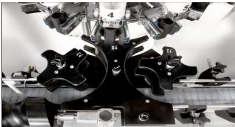
Снимка XI – 14. Зареждащо зъбно колело(звезда) от плакначна машина на фирма MBF S.p.A.
