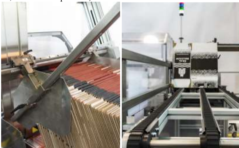
Снимки XI – 96 и 97. Част от устройства за съхранение и подаване на сгънати кашони, модели ACL или ACF на Bortolin Kemo S.p.A.
