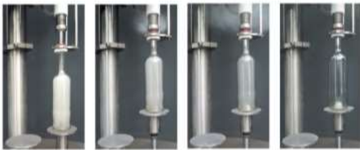
Снимки XI – 17, 18, 19 и 20. Инертизация с инертен газ на бутилка, пълна с дим; снимка MBF S.p.A.
