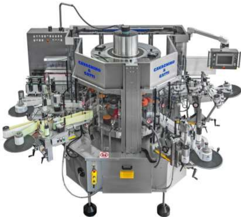
Снимка XI – 87. Етикетираща машина със самозалепващи етикети от серия CG T-TL-CLR-E на CAVAGNINO & GATTI S.p.A.
