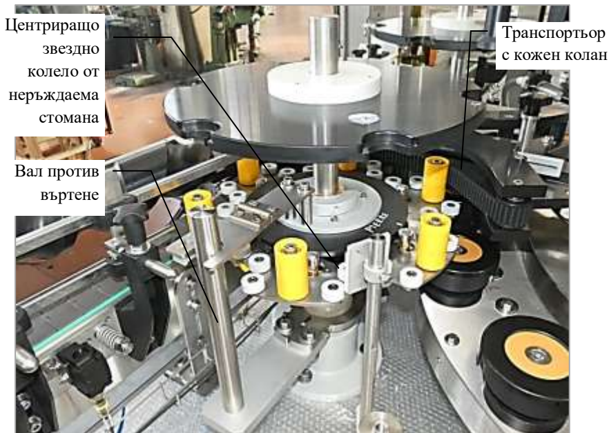
Снимка XI – 82. Механичните компоненти, изграждащи задвижваната центрираща звезда са транспортър с кожен колан, центриращо звездно колело от неръждаема стомана и вал против въртене от етикетиреща машина на CAVAGNINO & GATTI S.p.A.
