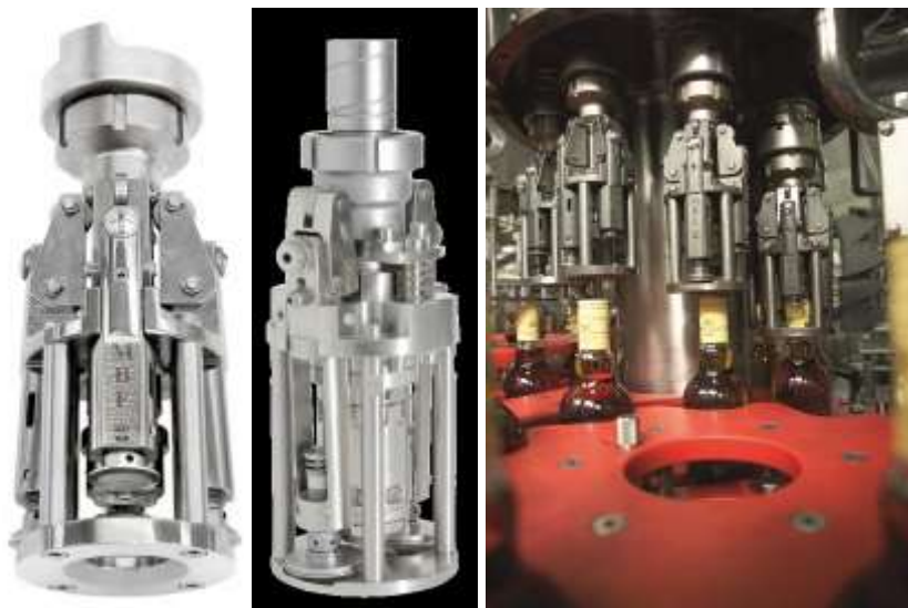
Снимки XI – 30,31 и 32. Различни варианти на затварящи глави и на машина с няколко затварящи глави в момента на затваряне на високоалкохолна напитка от MBF S.p.A.
