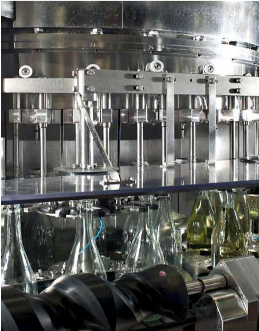
Снимка XI – 21. Част от процеса на бутилиране на бяло вино с пълначно-дозираща машина на MBF S.p.A.
