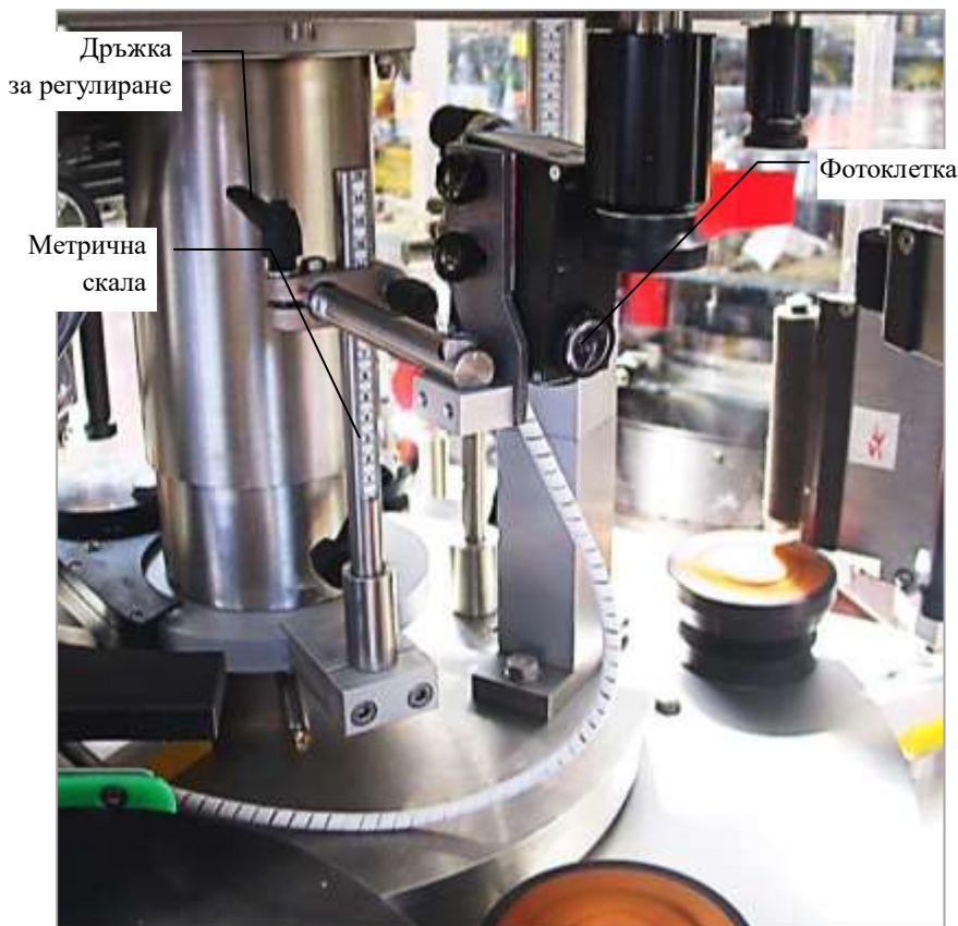
Снимка XI – 79. Оптично устройство с единична фотоклетка на CAVAGNINO & GATTI S.p.A.
