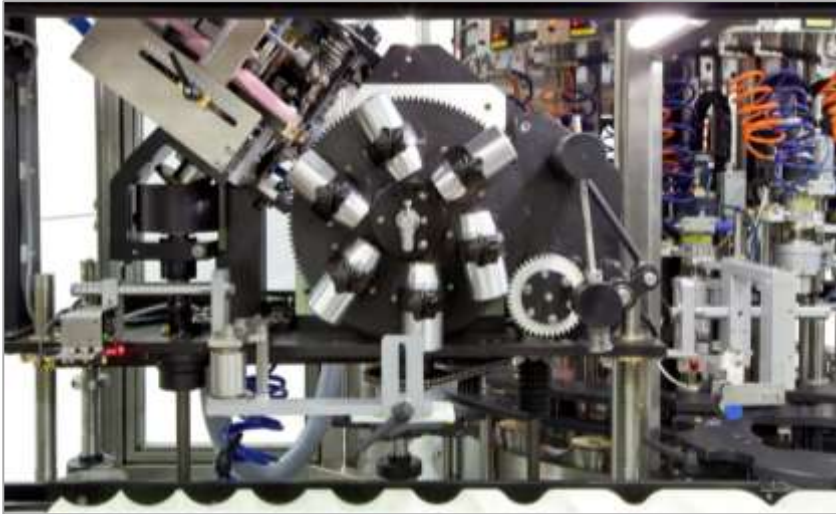
Снимка XI – 51. Автоматичен дозатор за капсули на Robino & Galandrino S.p.a.
