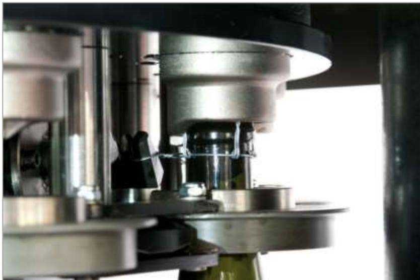
Снимки XII – 1, 2 и 3. Последователност от операции за поставянето и връзването на кошнички от машина на ROBINO & GALANDRINO S.p.A.
