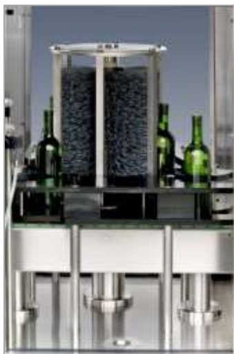
Снимки XI – 71 и 72. Почистване с ротационни четки на бутилки от миячно – сушилна машина на OMAR R&G s.r.l.
