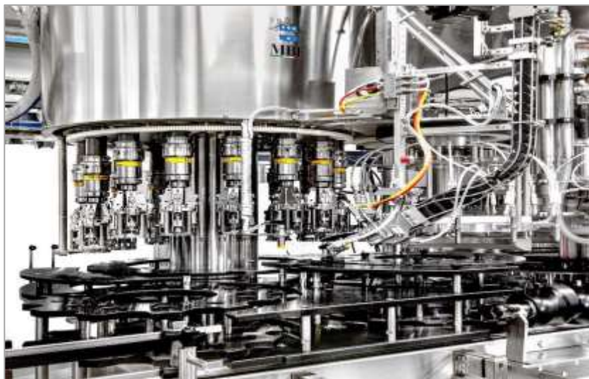
Снимка XI – 35. Затваряща машина с няколко затварящи глави от серия CAPTMATIC на MBF S.p.A.
