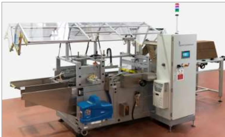
Снимка XI – 94. Машина за сглобяване на кашони серия FCE на Bortolin Keto S.p.A
