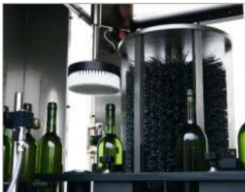
Снимки XI – 71 и 72. Почистване с ротационни четки на бутилки от миячно – сушилна машина на OMAR R&G s.r.l.
