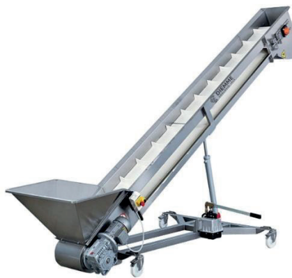
Наклонен лентов транспортър от фирма DIEMME Enologia S.p.A.
