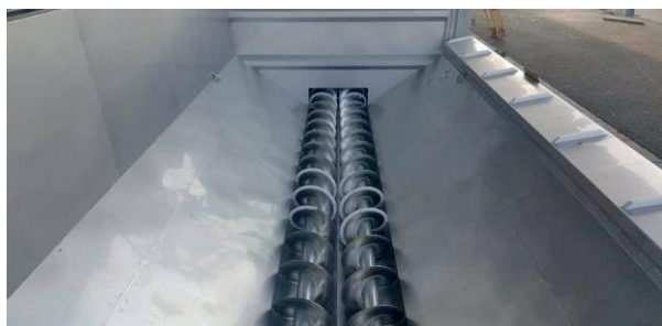
Приеман бункер за грозде от шнеков тип на фирма DIEMME Enologia S.p.A.
