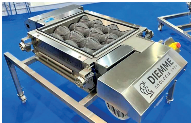
Машина за смачкване на грозде от фирма DIEMME Enologia S.p.A. – иновативна (позволява пълно преобръщане на ципата).
