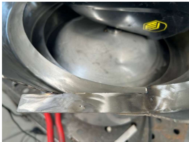
Фиг. 4. Оформяне на изход на вибробункера
