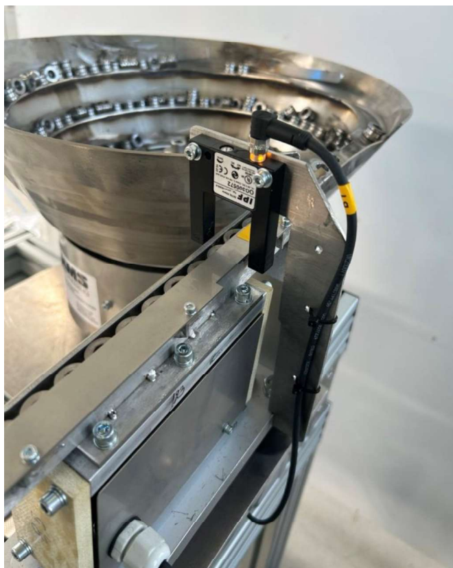
Фиг. 5. Преход между вибробункер и ЛВТ
