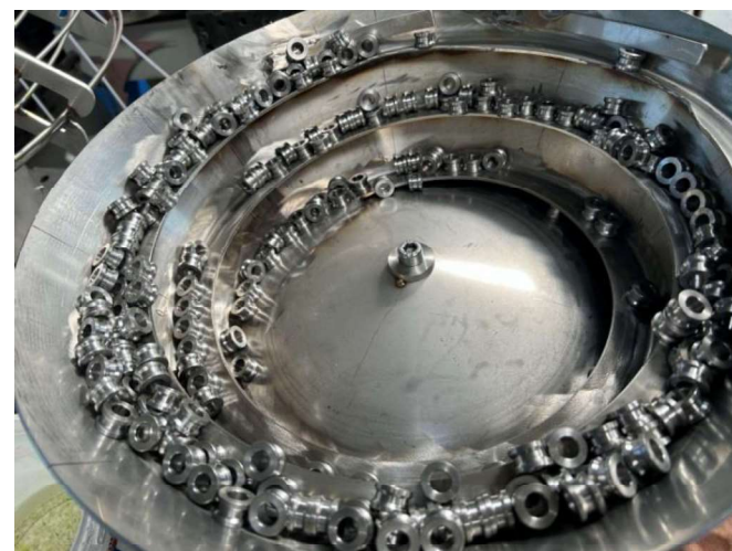
Фиг. 3. Допълнителен ориентиращ елемент от тип пластина
