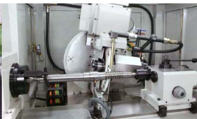
б) Работна зона на шлифовъчна машина за обработване на къси резбови профили
