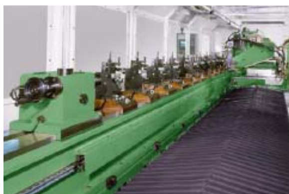
а) Шлифоване на дълги подавателни винтове с неподвижни люнета
