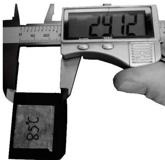
Фиг.3 Измерване на изкривяването на модела
