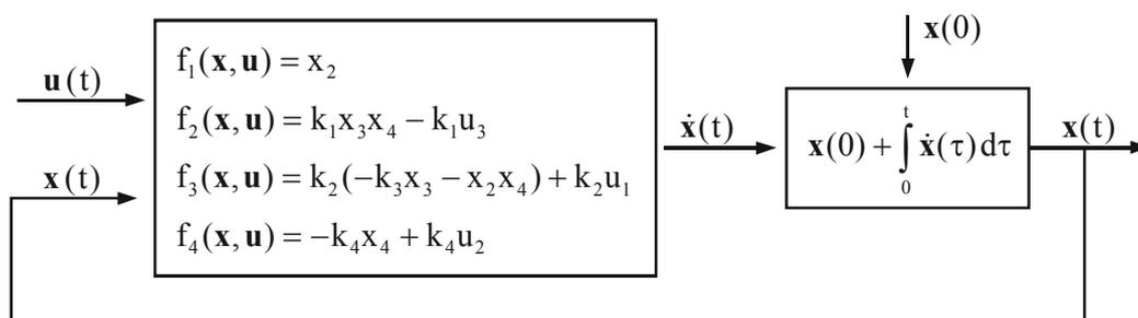
**Фиг.1.** Структурна схема на отворената система в пространство на състоянието
