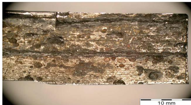
Fig. 5 Разрез на темплет на вътрешна повърхност на заварено съединение с дефекти
