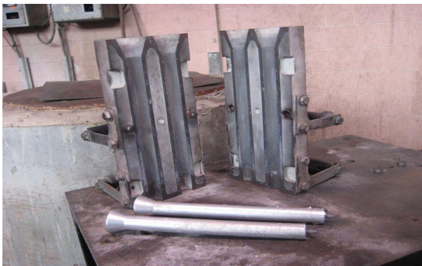
Фиг. 4.1 Общ вид на екипировката за отливане на аноди от сплав AlZn4
