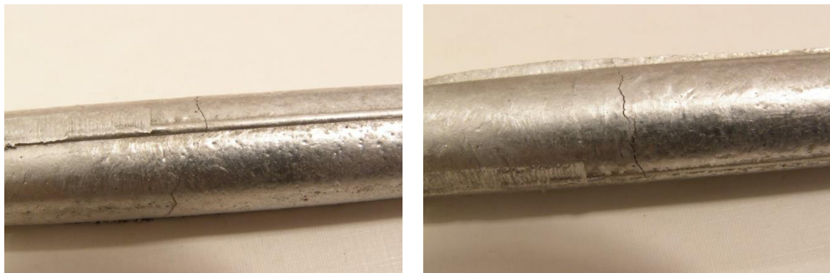
Фиг.4.11 Пукнатини в анодите от немодифицирана сплав AlZn4.
