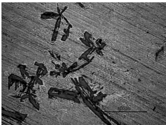
Фиг.3.5 AlSi18 модифицирана със SiC
