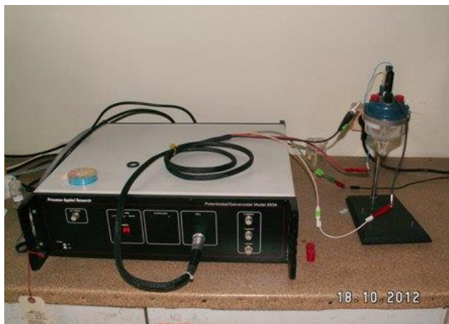
Фиг.4.3 Аналитична клетка с потенциостат-галваностат 263А-1 (USA)
