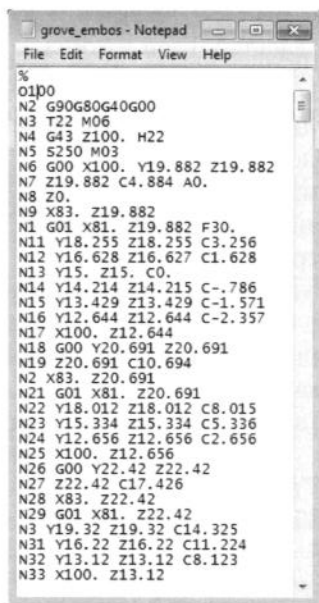
Фиг. 7. Част от управляваща програма за обработване на първа група канали
