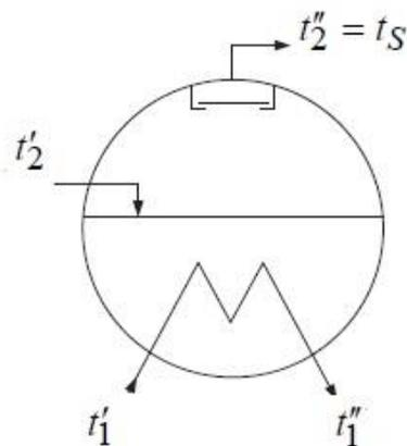
**фиг. 2 Топлинна схема на парогенератор ПГВ – 1000**
