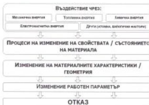
Фиг.3 Блок-схема на възникването на отказите
