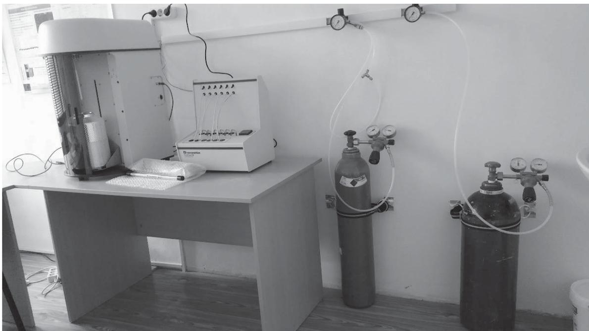
Фиг.1. Апаратура за измерване на адсорбция-десорбция TriSTAR II 3020, Micromeritics в лабораторията по „Системи и устройства за опазване на околната среда в топлоенергийни обекти" при ТУ-София.
