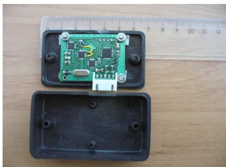
Фиг. 3. Инерциална измервателна система
