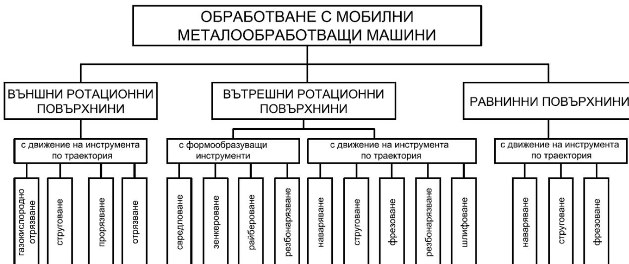
**Фиг. 1. Класификация на мобилните металообработващи машини според метода за обработване**
