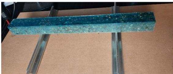
Фиг. 3. Опитна установка за определяне на  $f_f$
