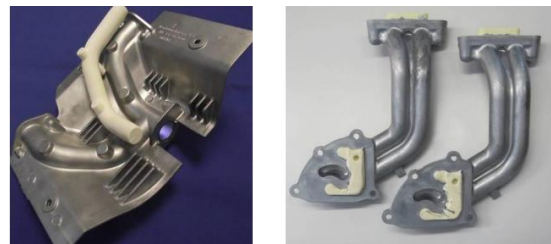
Фиг. 15 Отливки със сложни вътрешни повърхнини, получени с помощта на метода Lost Cores [11]
