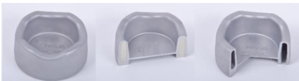
Фиг. 13 Детайл и детайл с неотстранена зложка. Демонстратор на технологията Lost Cores [8]
