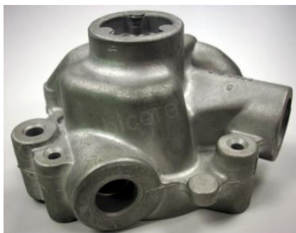
Фиг. 6 Лята под налягане част с полумрежова форма с интегриран маслен канал Combicore [3]
