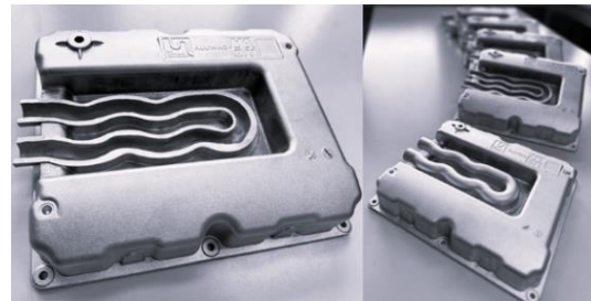
Фиг. 10 Отливка получена чрез процеса „Инжектиране на газ в стопилката по време на процеса на леене“ [6]
