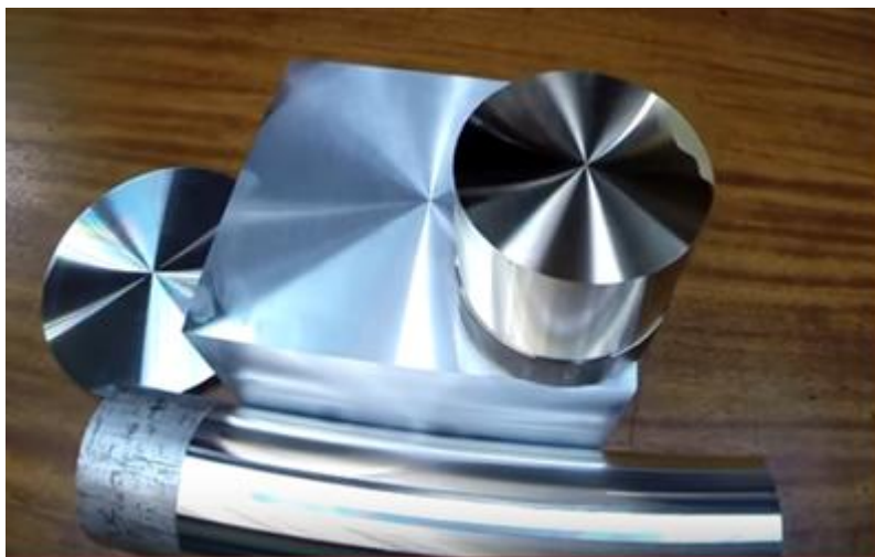
Фиг.4 Огледални повърхности с високо качество на метални детайли, получени след диамантено струговане [7]
