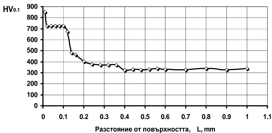
Фиг. 5. Диаграма на изменение на микротвърдостта HV 0.1 по дълбочина на карбонитрирания слой на стомана 30CrMoV9.
