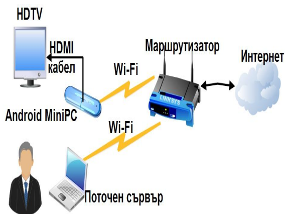
Фиг. 1. Модел на домашна IPTV мрежа
