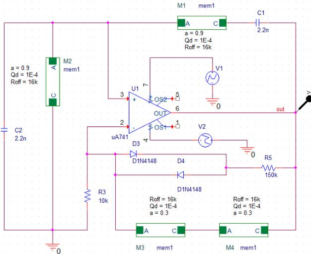
Fig. 2. Memristor Wien generator
