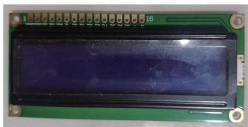
图3 1602LCD 液晶显示屏
