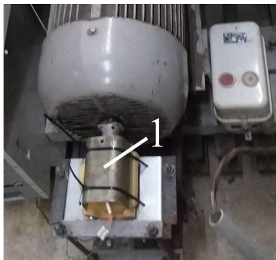
ФИГУРА 3. Тахогенератор (1), монтиран на вала на електродвигателя на инерционния лабораторен стенд.
