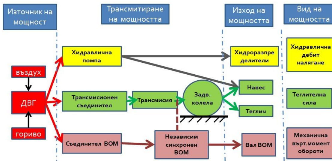
Фиг.1. Функционална структура на трактора
