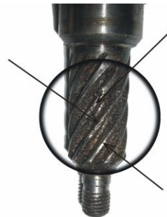
Износване на пиньона
