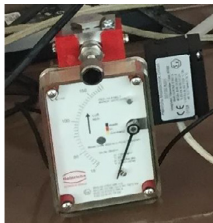
фиг. 2. Ротаметър за прецизно измерване на въздушния поток.
