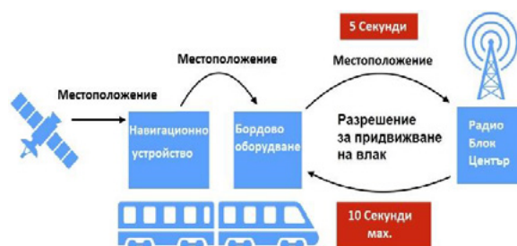
Фиг. 4: ERTMS подвижна блокова железопътна сигнализация
