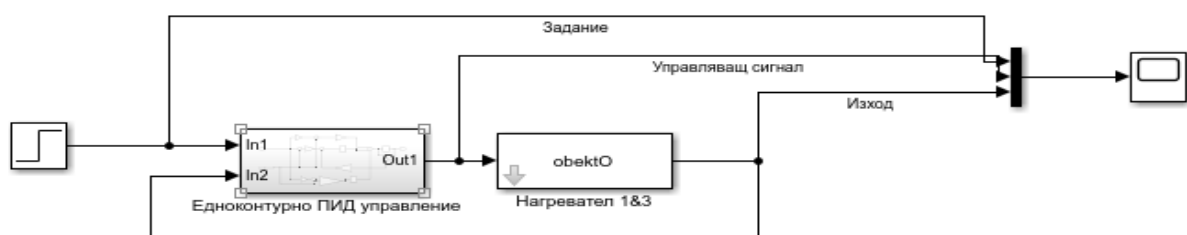
Фиг. 3. Едноконтурно ПИД управление – структурна схема
