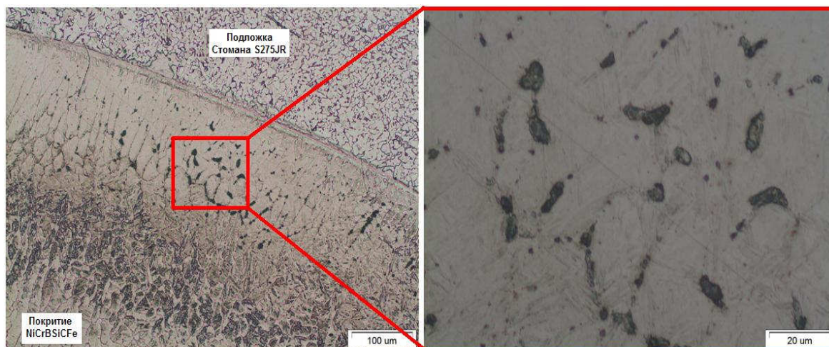
Фиг. 5. Зона на сплавяване за образец PS1.1 .
