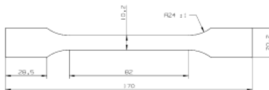
Фиг.7 Размери за машинна обработка на формообразуващата кухня на пробното тяло
