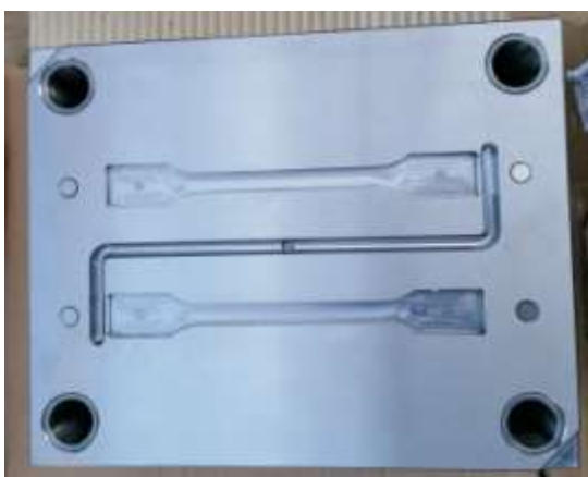
Фиг.8 Формообразуваща кухня на шприцформата преди йонно азотиране
