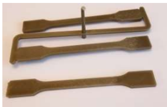
Фиг.9 Тестови универсални пробни тела тип А1 спрямо стандарт БДС EN ISO 20753:2019
