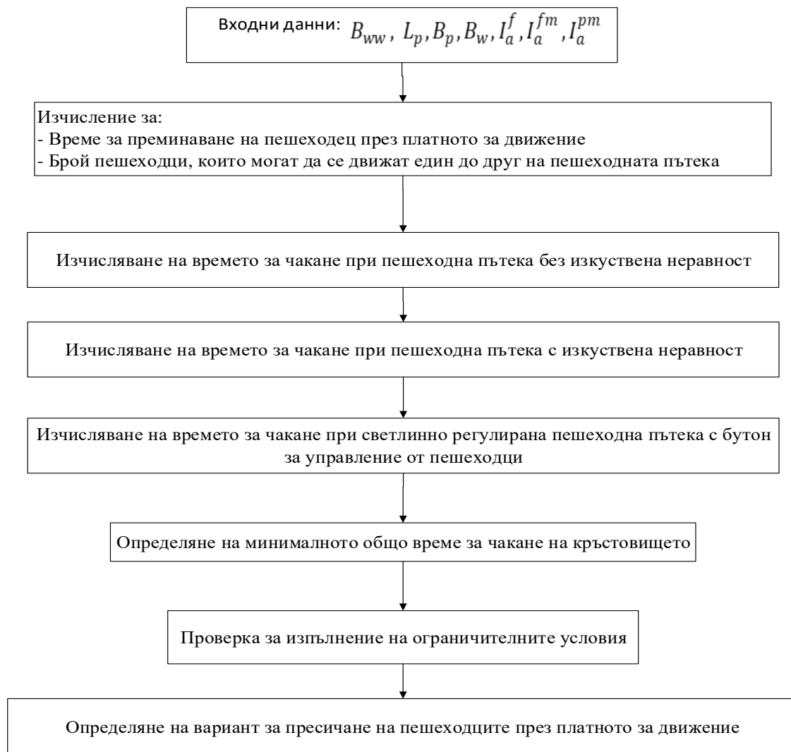
Фиг. II.1.4 Обобщен алгоритъм за определяне вида на преминаване на пешеходци през платното за движение при определени транспортни условия
