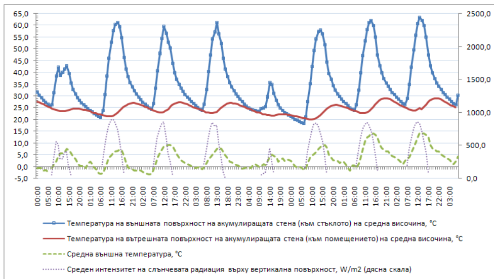
Фиг. 2. Експериментални данни за температурните полета в стена на Тромб
