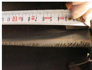
Фиг. 3. Констатирани нецялостности на основен метал при визуален контрол в резултат на циклична умора
