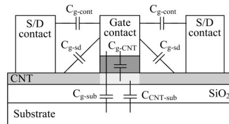
FIG. 7 PARASITIC CAPACITANCES AFFECTING THE CNTFET
