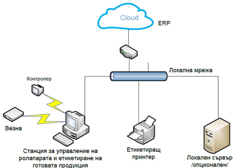
Фигура 2. Структура на спомагателна система за управление на ролепарат.
