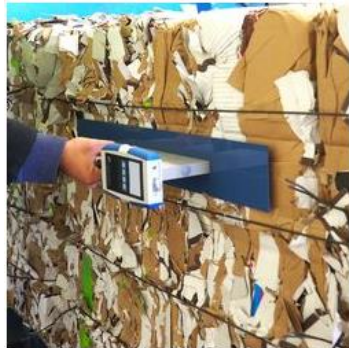
Фиг.5. Влагомер Humimeter RP6 за измерване на влагата в бали с отпадъчна хартия.
