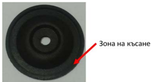
Фиг. 1. Армирана мембрана за електро-пневматичен вентил.
