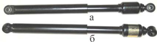
Фиг. 2. Общ вид на изследваните кормилни демпфери.
