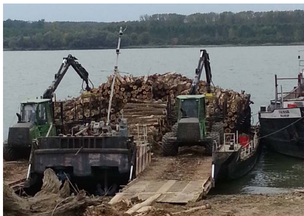
Фиг. 2. Натоварване на платформата с дървесина от двата сортиментни трактора.
