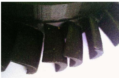
Фиг. 3. Разрушаване на лопатката.
