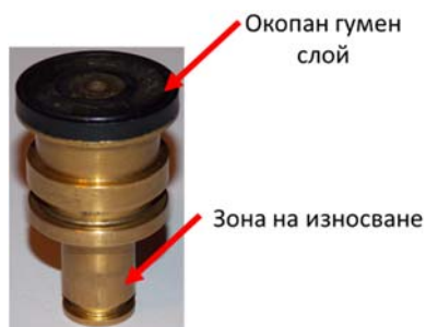
Фиг. 5. Металогумен клапан за кран-машинист за директната спирачка тип SA1 – подходящ за рециклиране.
