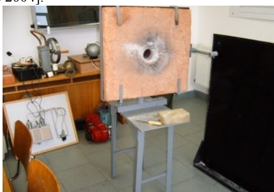
Фиг. 2. Експериментална уредба с възможност за създаване на радиална струя.
