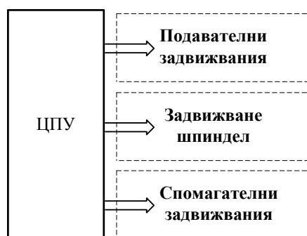
Фиг. 1. Обобщена блокова схема на системата за задвижване.
