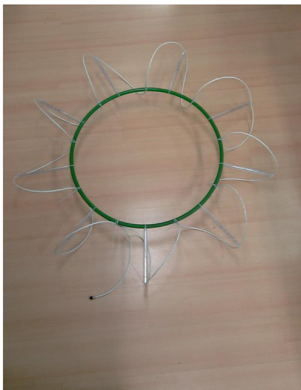
Фиг. 3. Снимка на реализирана радиална магнитна сонда за експериментални изследвания
