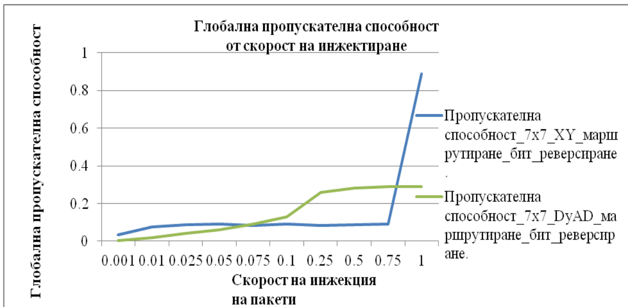
Фиг.3.11 - Зависимост глобална пропускателна способност от скорост на инжекция за мрежа 7 x 7 XY маршрутиране XY и за DuAD
