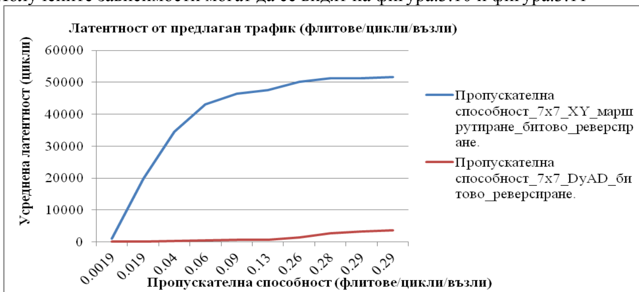
Фиг.3.10 Зависимост на латентността от предлаган трафик за мрежа 16 x 16 XY маршрутиране XY и за DyAD
