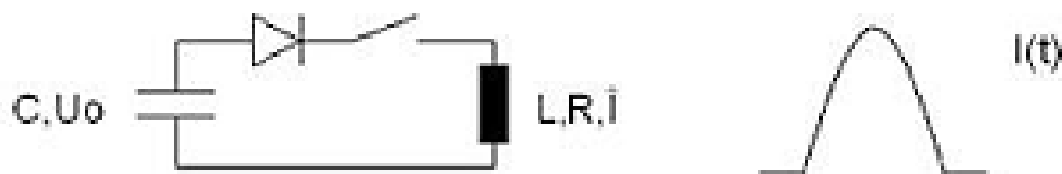
Фиг.1. Електрическа схема за реализиране на токов импулс със синусоидална форма и продължителност един полупериод.
